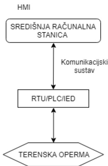
Sl. 2.4. Prikaz komponenti SCADA sustava [1]
