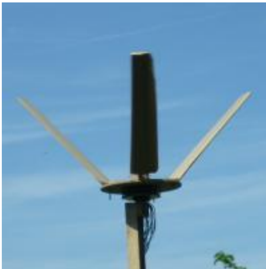
Slika 1.18. V – vertikalna vjetroturbina [7]
