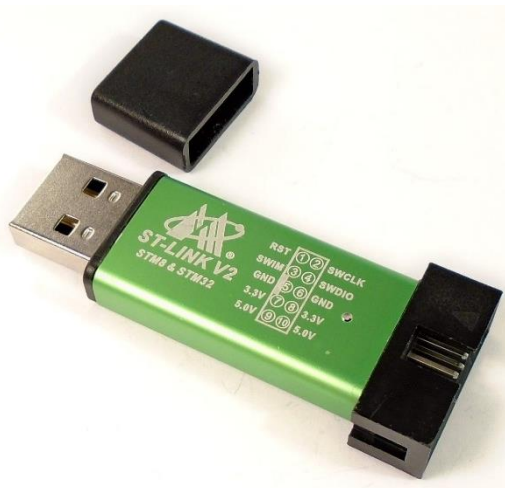
Slika 3-1 ST-Link V2 USB programator
