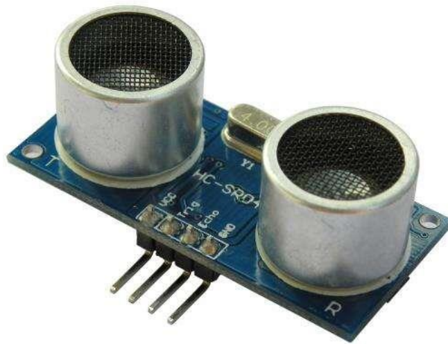
Slika 0-4 HC-SR04 Ultrazvučni senzor
