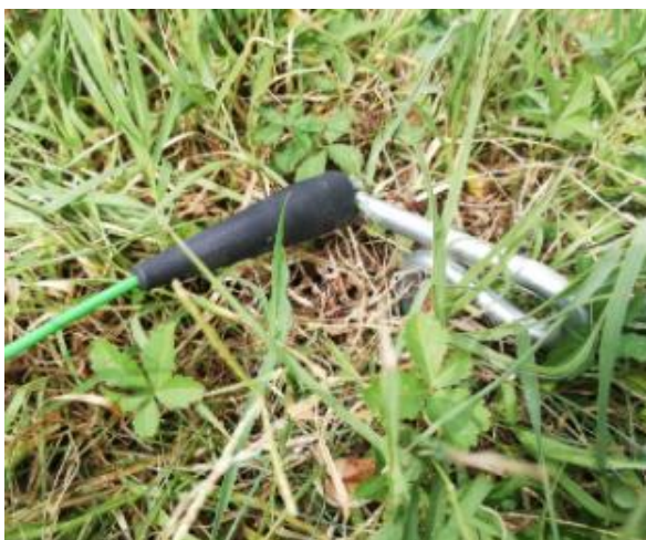
Slika 4.4 Pomoćna naponska sonda
