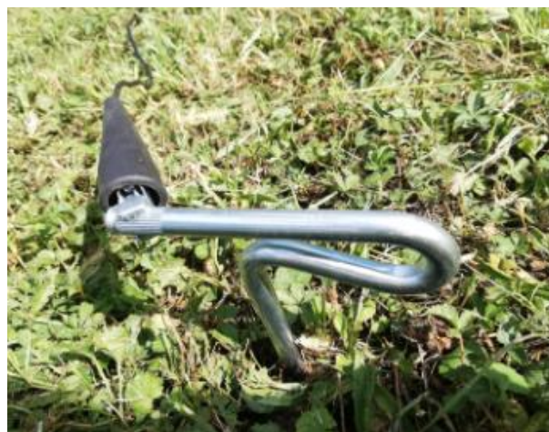
Slika 4.3 Pomoćna strujna sonda
