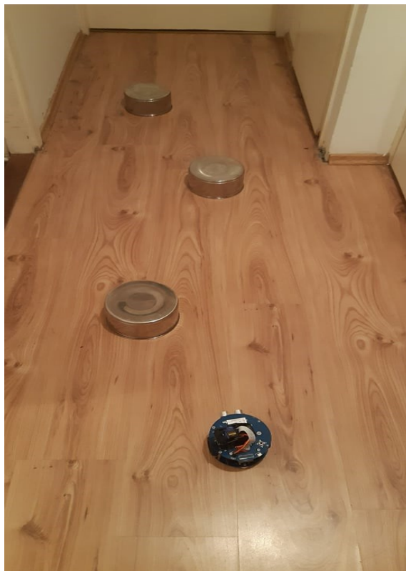
Slika 4.1 Staza za testiranje ultrazvučnog senzora
