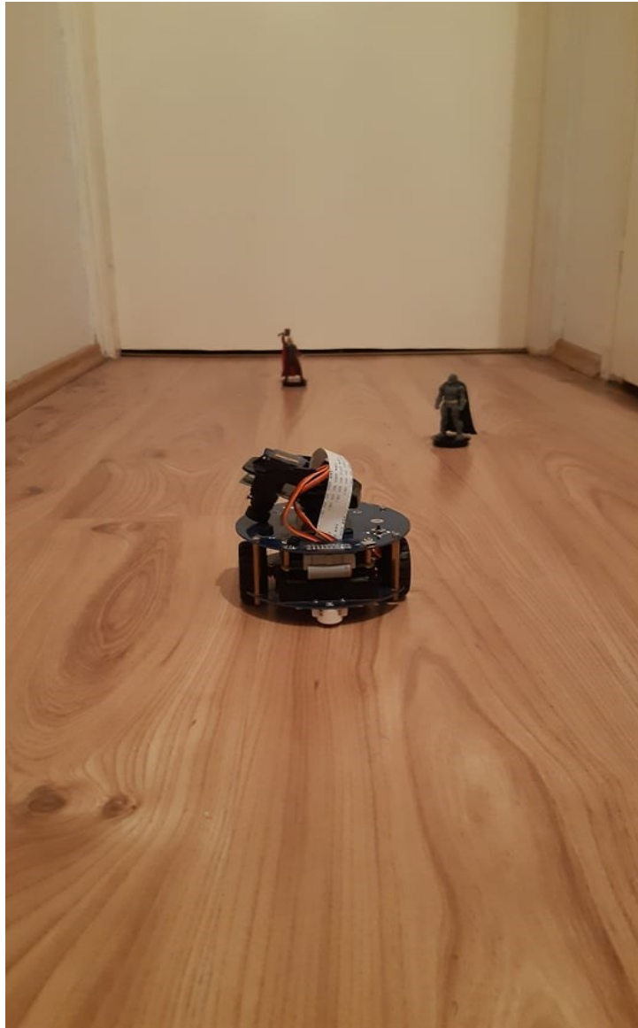
Slika 4.2 Staza za testiranje senzora slike
