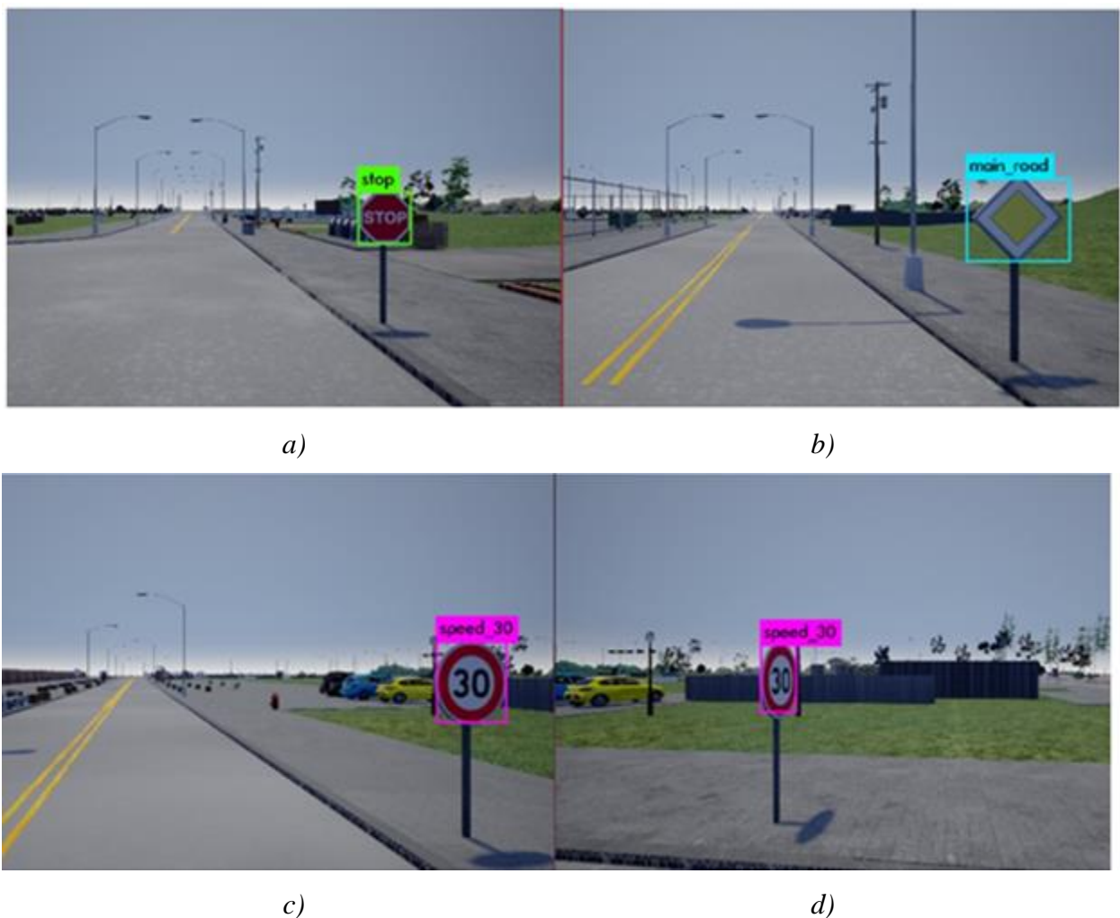
Sl. 3.18. Točna detekcija (a) znaka obaveznog zaustavljanja, (b) znaka ceste s prednošću prolaska, (c) znaka ograničenja brzine 30 km/h i (d) zakrenutog znaka ograničenja brzine 30 km/h.
