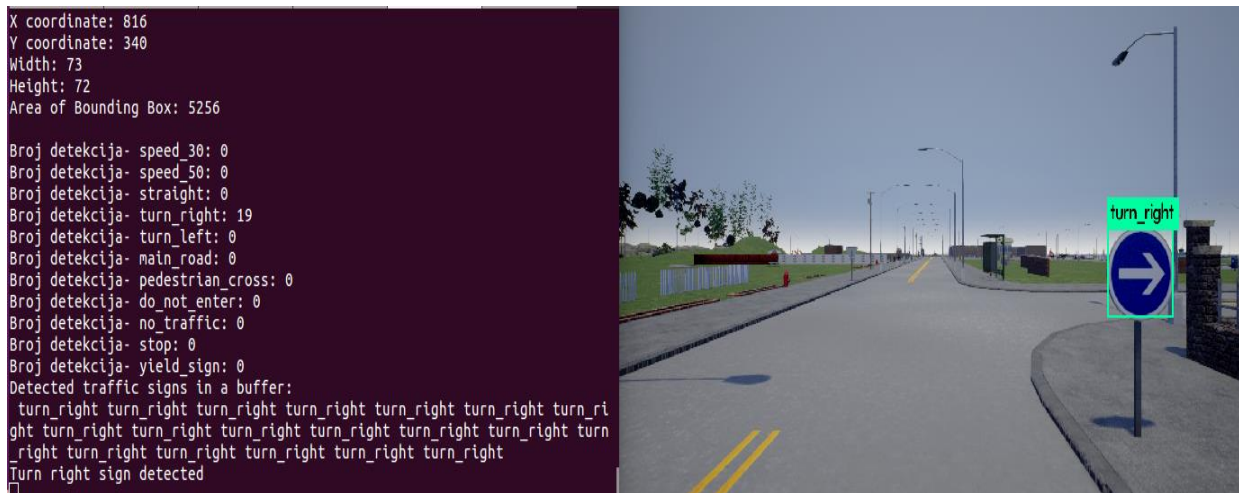
Sl. 3.24. Detekcija znaka za obavezno skretanje desno i slanje naredbe za upravljanje.
