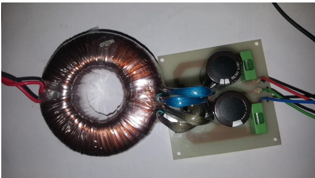
Slika 4.7. Ispravljač i transformator
