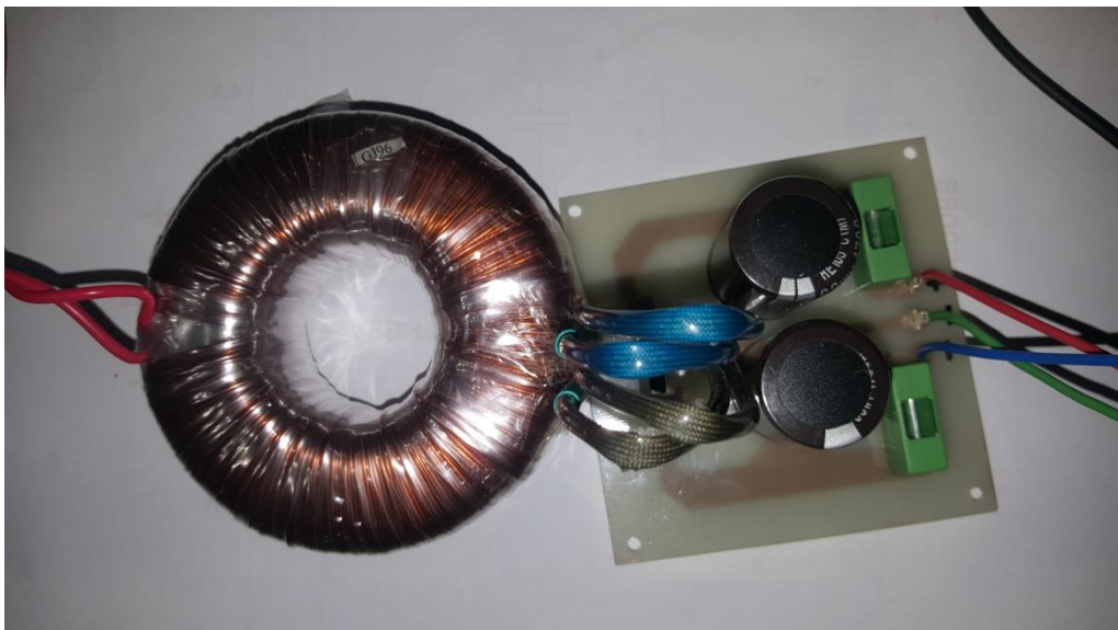
Slika 4.7. Ispravljač i transformator
