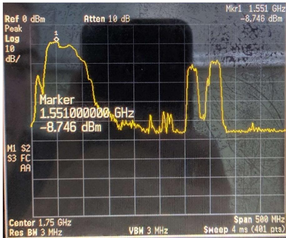
Slika 5.5. Rezultati mjerjenja sa uključenim uređaj za ometanje signala.
