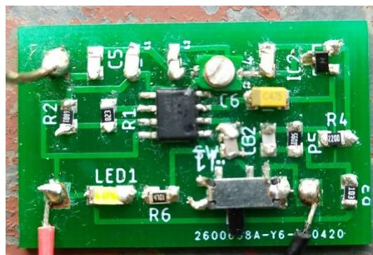
Slika 5.3. Detaljan izgled sklopa uređaja za ometanje signala.
