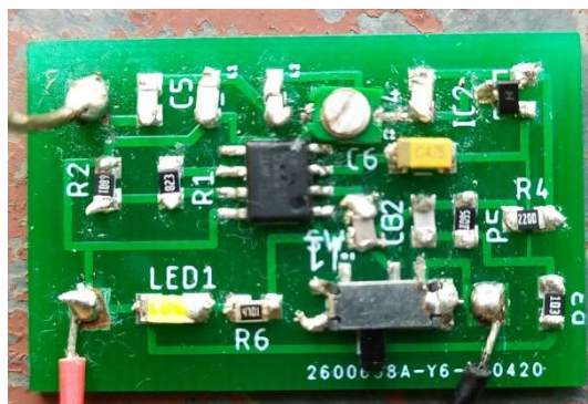
Slika 5.3. Detaljan izgled sklopa uređaja za ometanje signala.
