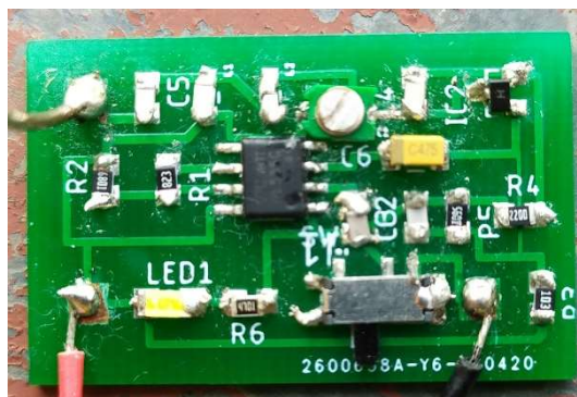
Slika 5.3. Detaljan izgled sklopa uređaja za ometanje signala.
