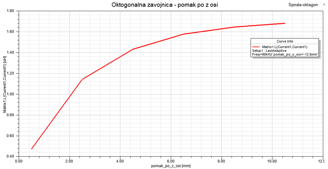
Slika 5.27. Promjena induktiviteta pomakom po z osi
