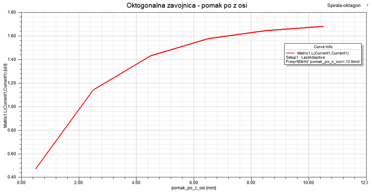
Slika 5.27. Promjena induktiviteta pomakom po z osi
