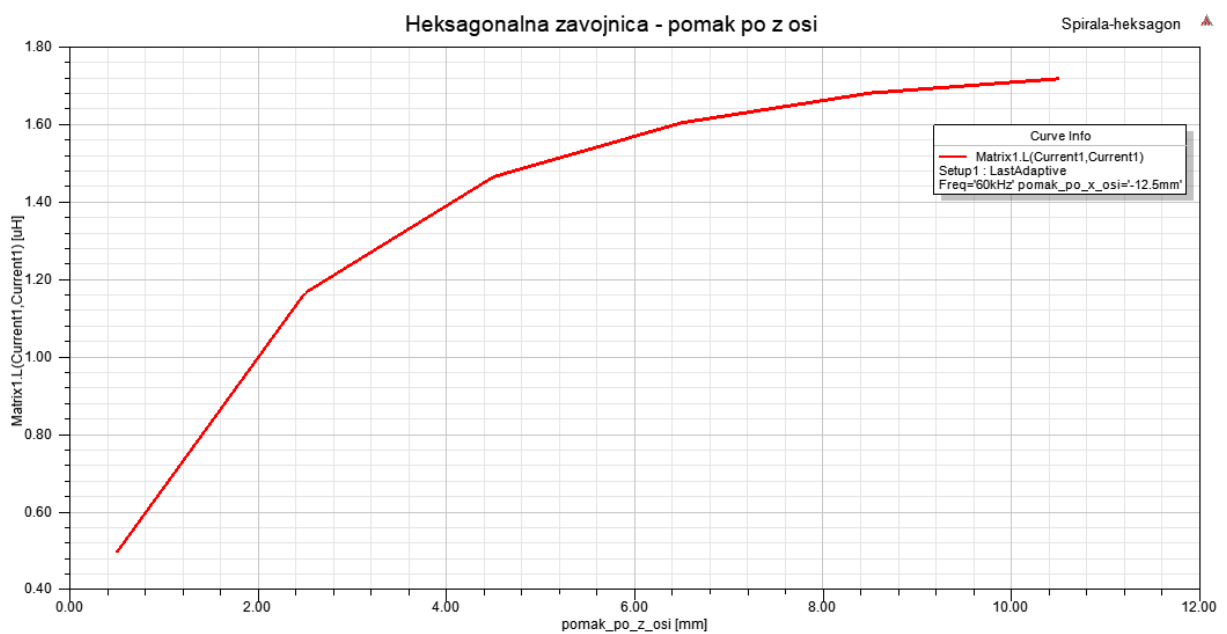
Slika 5.22. Promjena induktiviteta pomakom po z osi
