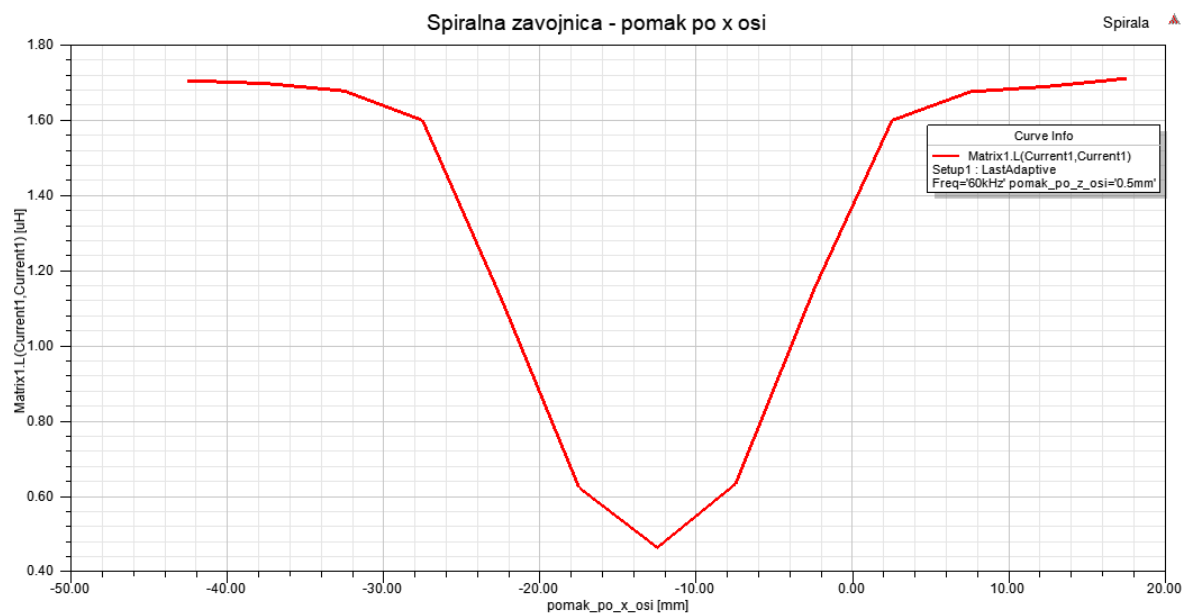
Slika 5.11. Promjena induktiviteta pomakom po x osi
