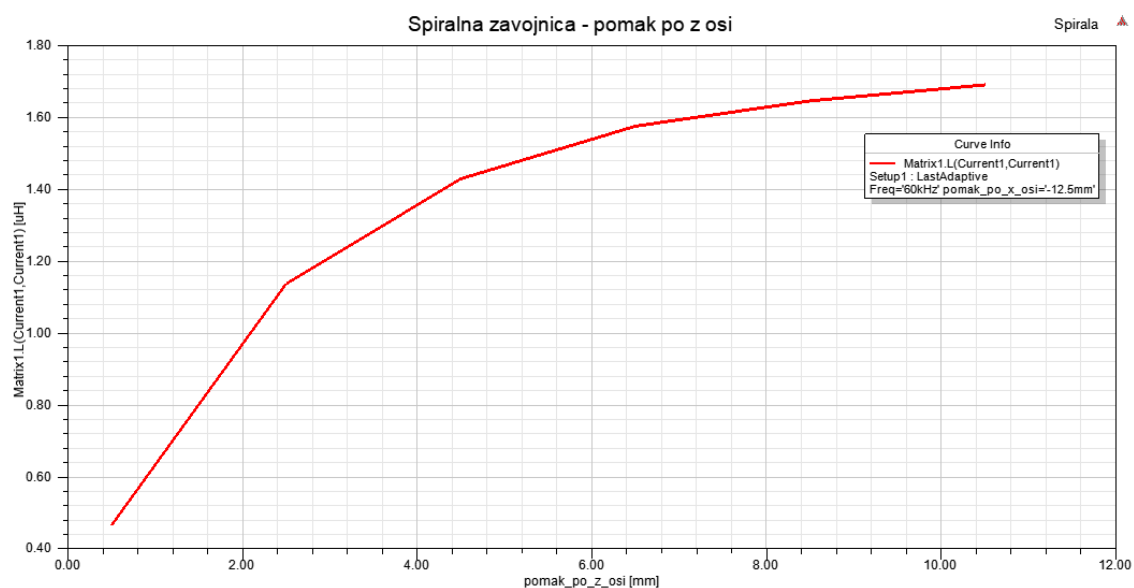
Slika 5.12. Promjena induktiviteta pomakom po z osi
