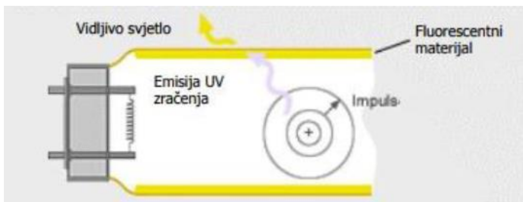
Slika 4.6. Pojednostavljeni prikaz principa rada fluorescentne cijevi
