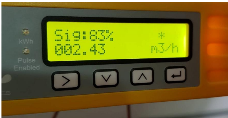
Slika 5.6. Prikaz snage signala i protoka.
