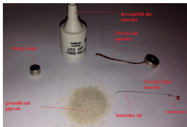
Slika 4.1. Dijelovi osigurača veličine D II, razreda gG, marke ETI, nazivne snage 10 A
