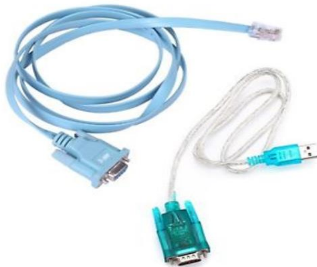
Slika 4.2 Konzolni i USB na serijal kabel
