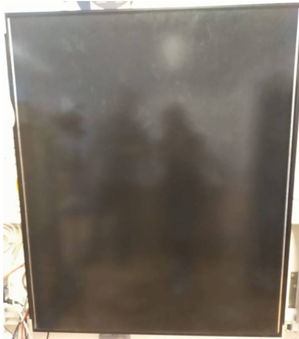
Slika 2.7. Fotonaponski modul – amorfni silicij
