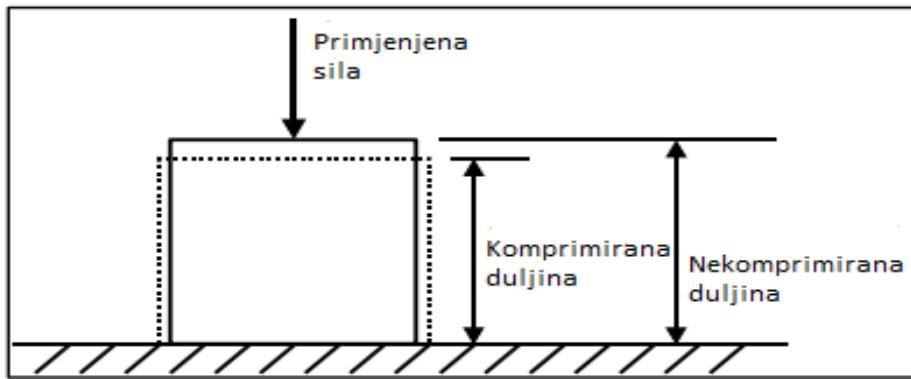
**Slika 3.2.** Osnovni dijagram elastičnog pretvaračkog elementa
