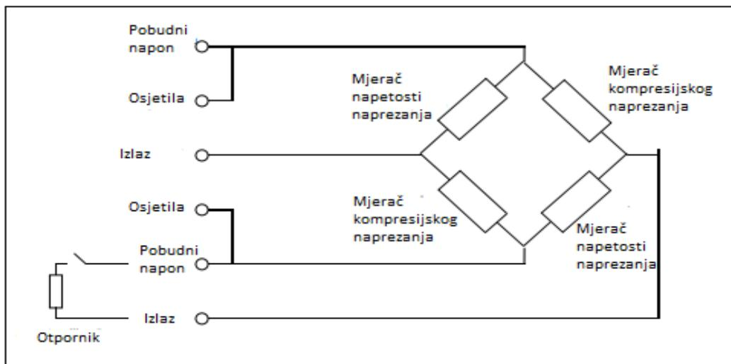
**Slika 3.4.** Osnovni raspored četiri mjerača opterećenja u ćeliji opterećenja
