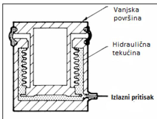
Slika 3.8. Primjer čelije s hidrauličnim opterećenjem.
