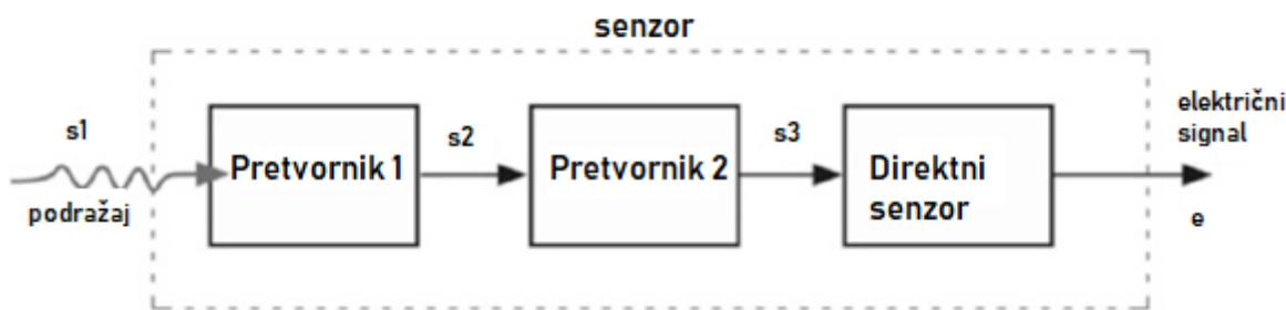
**Senzor 2.4.** Senzor s ugrađenih nekoliko pretvornika (transducera)
