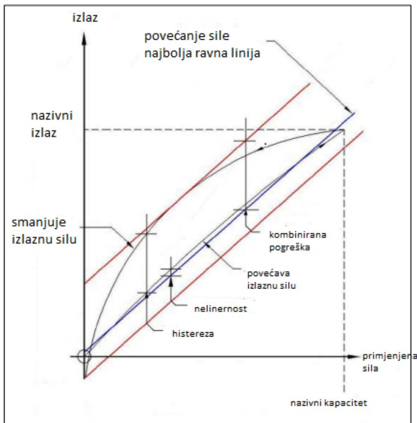
**Slika 3.** Tipične izlazne karakteristike sustava za mjerjenje sile
