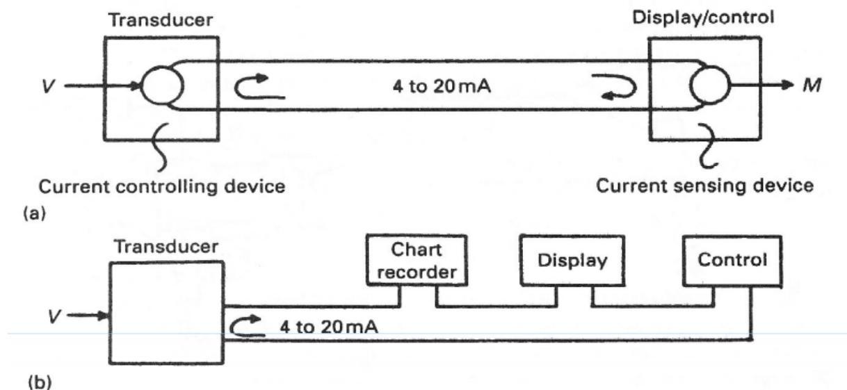
**Slika 5.1.** Sustav prijenosa s jakosti 4 do  $20\text{ mA}$  strujne petlje
