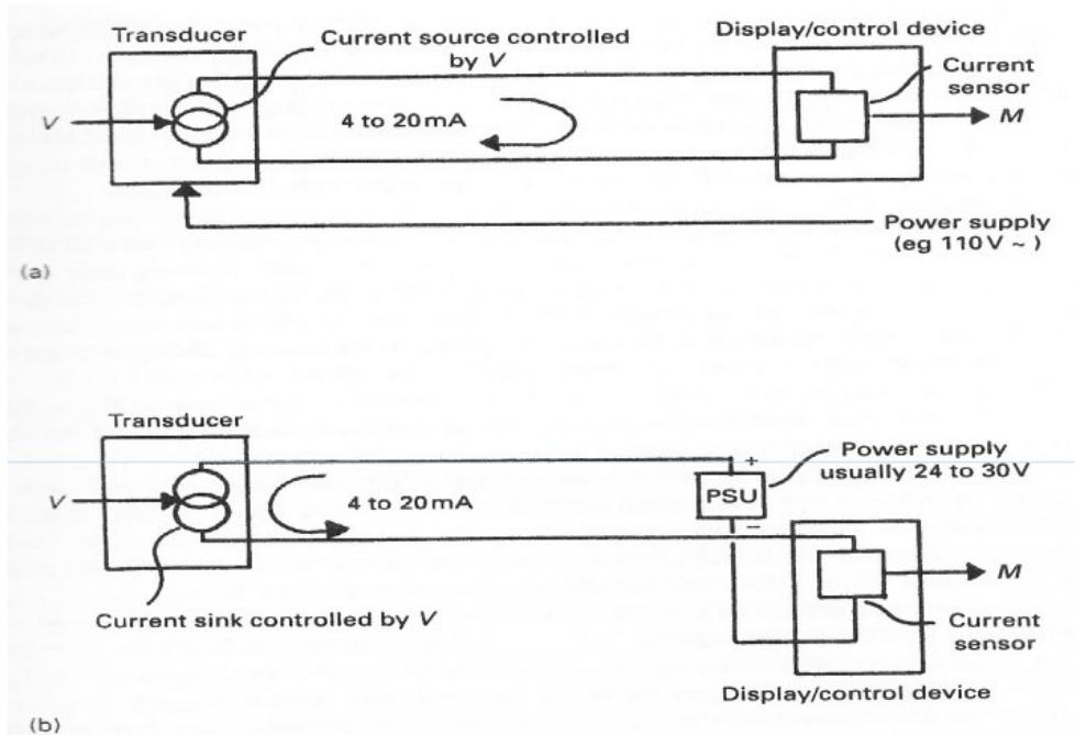
**Slika 6.1.** Strujne petlje: a) prijenosnici sa posebnim izvorom energije i b) prijenosnici s dvonamjenskim kabelima
