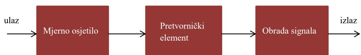
**Slika 6.2.** Struktura mjernog pretvornika
