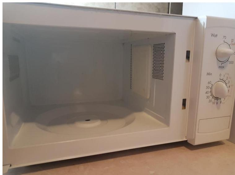
**Slika 3. 7.** Komora za zagrijavanje bez rotacijskog tanjura.
