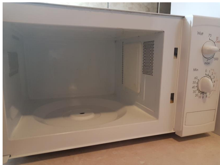
Slika 3. 7. Komora za zagrijavanje bez rotacijskog tanjura.
