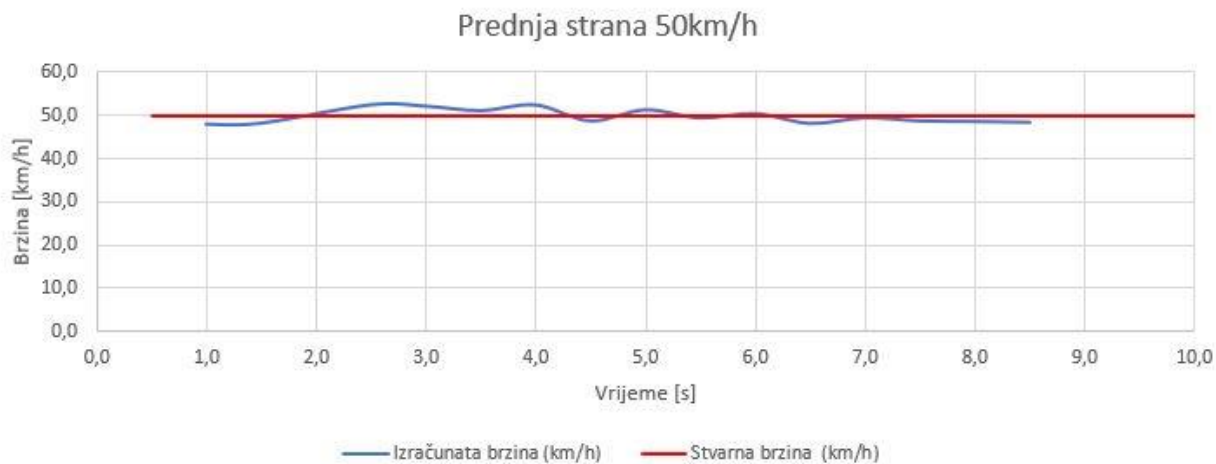
Slika 4.55. Prikaz brzine za prednju stranu automobila pri brzini 50km/h
