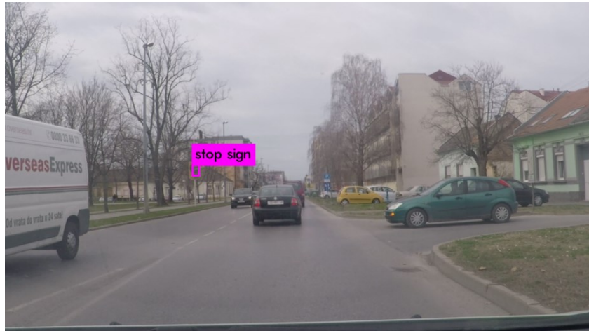
SI.3.12. Detekcija nepoznatog objekta pored ceste kao znaka obaveznog zaustavljanja.
