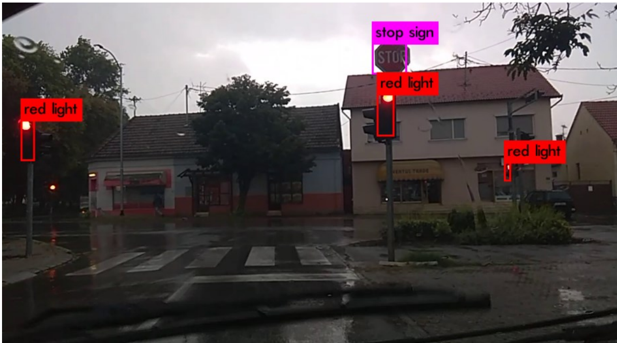
Sl. 4.3. FP detekcija semafora za pješake s uključenim crvenim svjetlom po kišnom vremenu.
