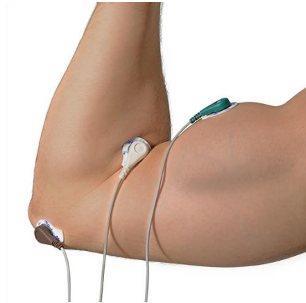
Sl. 5.6 Spajanje EMG senzora na korisnikov biceps [17]
