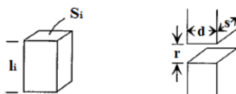
Slika 2.7. Puni element (lijevo na slici), element s zračnim rasporom (desno) [12]
