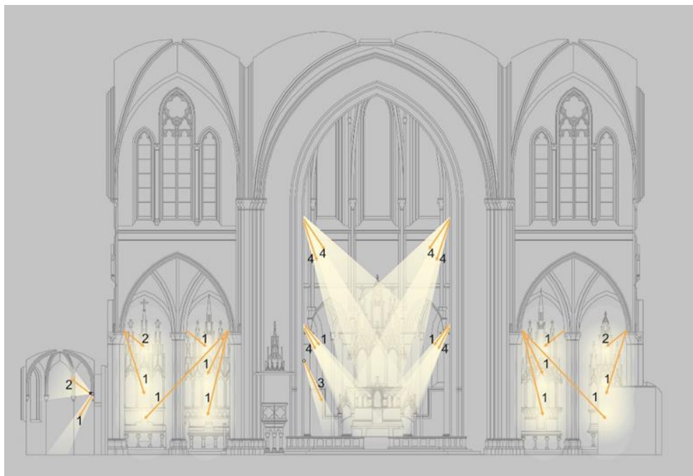
Slika 6.13 Skica načelnih pozicija rasvjetnih tijela za rasvjetu glavnog oltara i pomoćnih oltara sa usmjerenjima snopova svjetlosti
