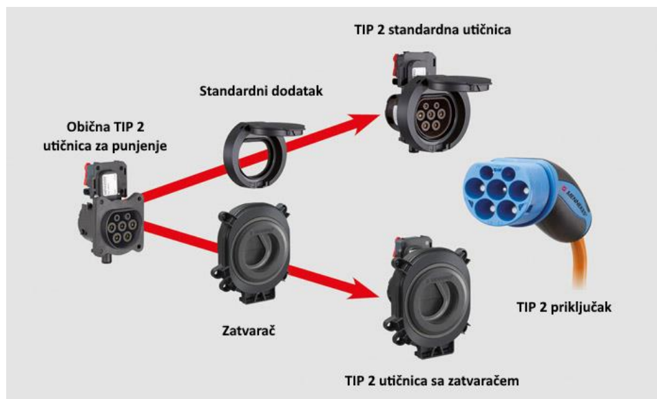
Slika 4.6 Tip 2 priključak i njegove izvedbe utičnice [14]
