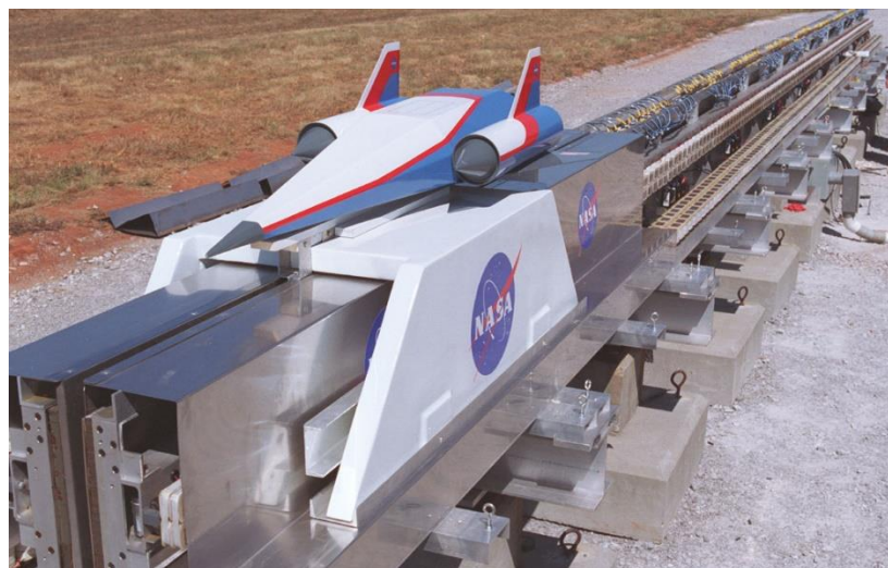
Sl. 2.3. Prikaz korištenja linearnog motora za izradu prototipa Maglev tračnice
