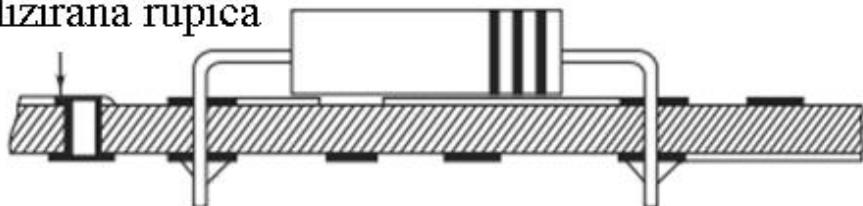
Sl. 3.3. Dvoslojna tiskana pločica sa metaliziranom rupicom [1].
