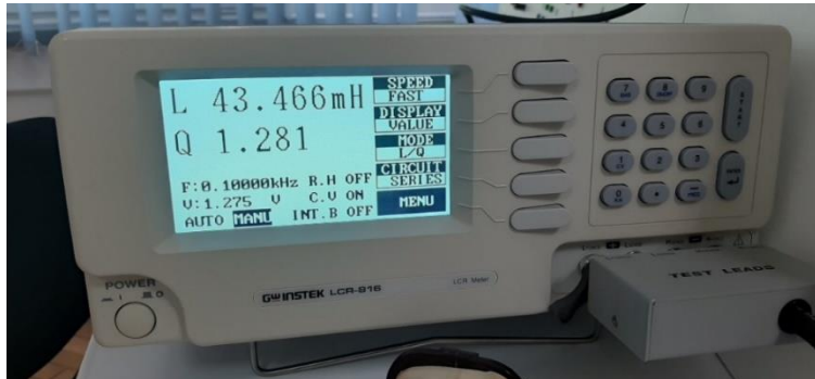
Slika 4. 12. Postavke instrumenta pri mjerenju zavojnice nazivnog induktiviteta 45[mH].
