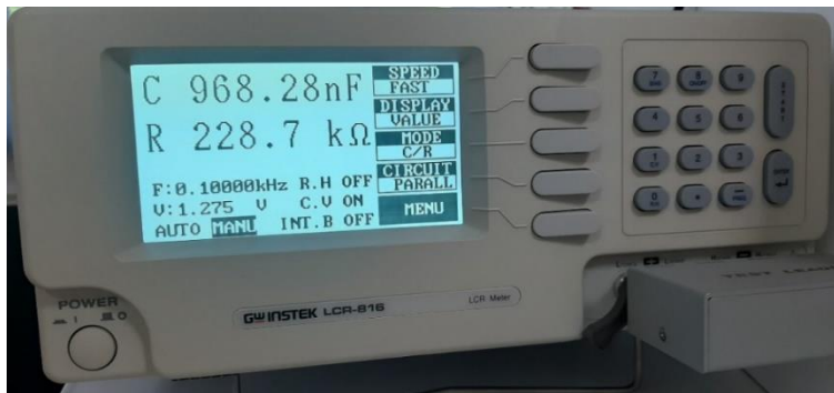
Slika 4. 22. Prikaz odabranih postavki pri mjerenju parametara u paralelnom nadomjesnom spoju.
