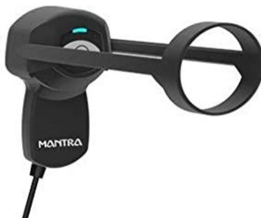
Slika 3.5. Prijenosni uređaj za skeniranje šarenice (preuzeto s [www.mantratec.com](http://www.mantratec.com))
