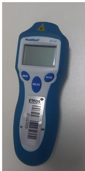
**Slika 6.8.** Uređaj za mjerjenje brzine vrtnje ventilatora
