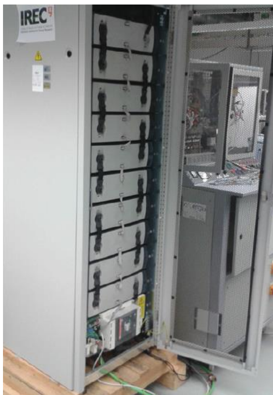
Slika 2.11. Litij-ionski baterijski sklop u IREC laboratoriju[1]
