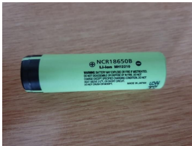
Slika 3.5. Izgled Panasonic NCR18650B baterijskog članka
