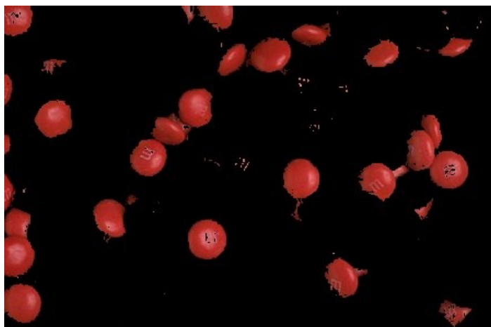
Sl. 7.26. Slatkiši crvene boje segmentirani pomoću amplitudne segmentacije
