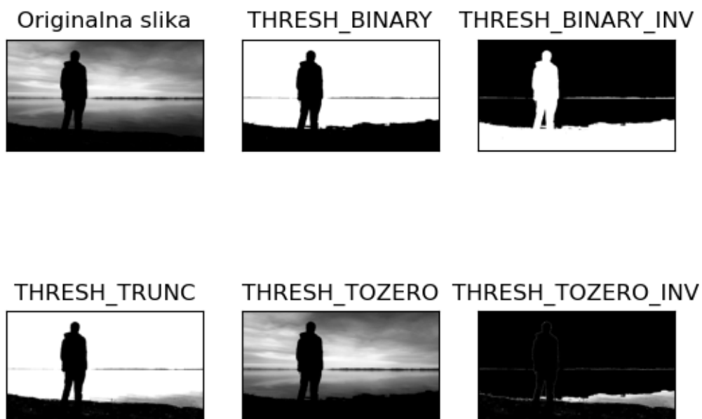
Sl. 7.1. Prikaz amplitudne segmentacije s manualnim postavljanjem praga uz različite threshold_type parametre. [29]
