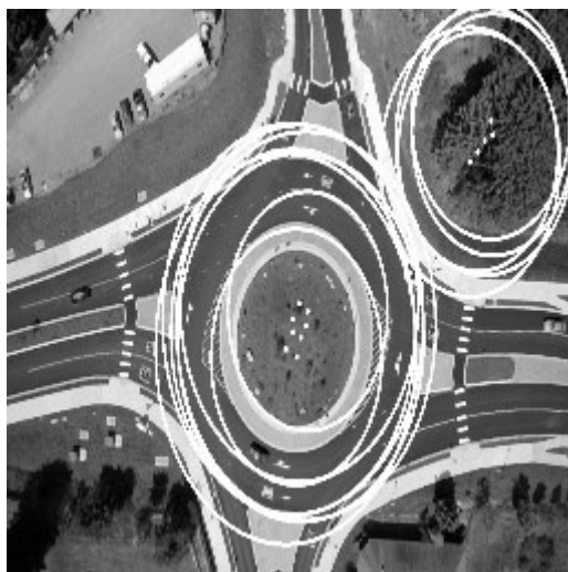
Sl. 7.24. Kružni tok sa slike 7.15. s ucrtanim kružnicama koje su nepotrebne za nalaženje područja kružnog toka
