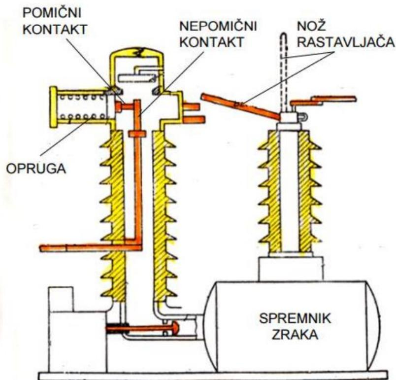
Slika 4.4 Zračni prekidač [1]
