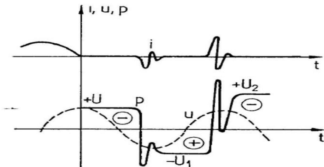
Slika 4.1 Isklopanje kapacitivne struje [1]
