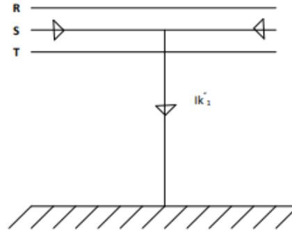
Slika 3.1 Tipovi kratkih spojeva [2]
