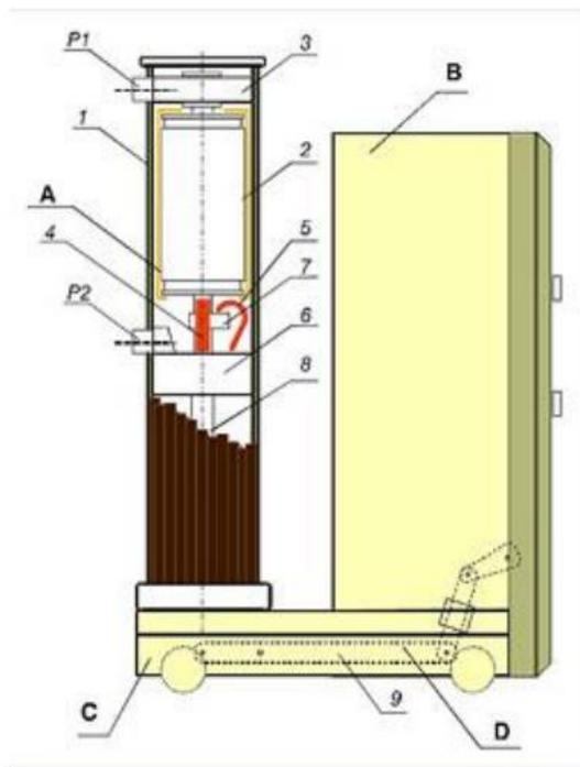
Slika 4.10 Vakuumski prekidač [10]
