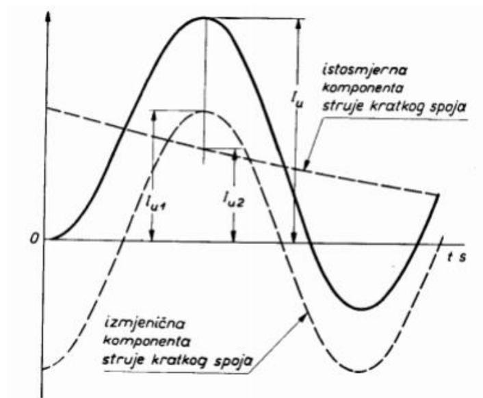
Udarne struje trebaju biti poznate radi određivanja maksimalnog naprezanja aparata i dijelova u postrojenju.
