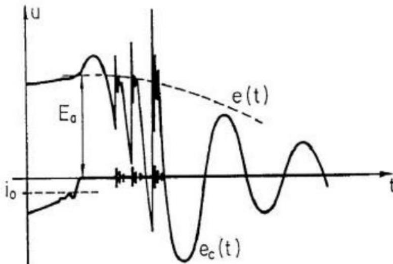
Slika 4.2 Isklapanje induktivne struja [1]
