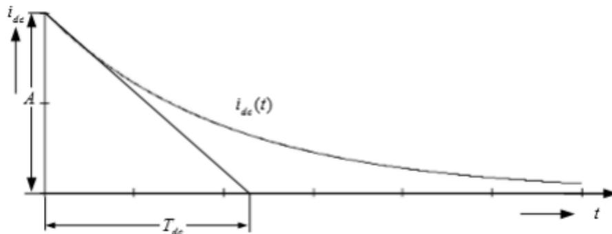
Slika 3.3 Istosmjerna komponenta struje kratkog spoja [1]
