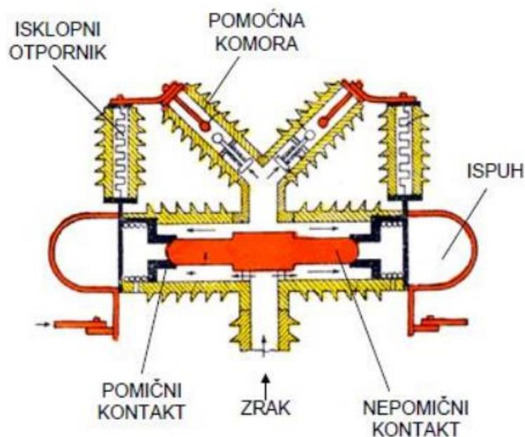
Slika 4.6 Pneumatski prekidač [1]
