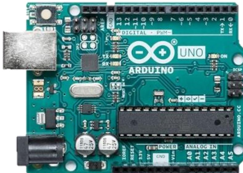
Slika 4.1.: Arduino Uno mikroupravljač[1]
