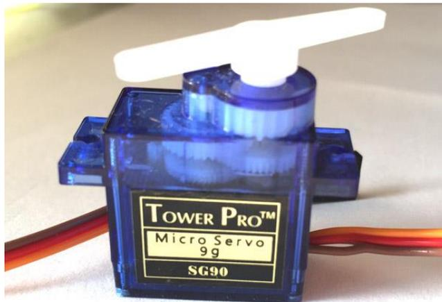
Slika 4.2.: Servo motor SG-90 [3]
