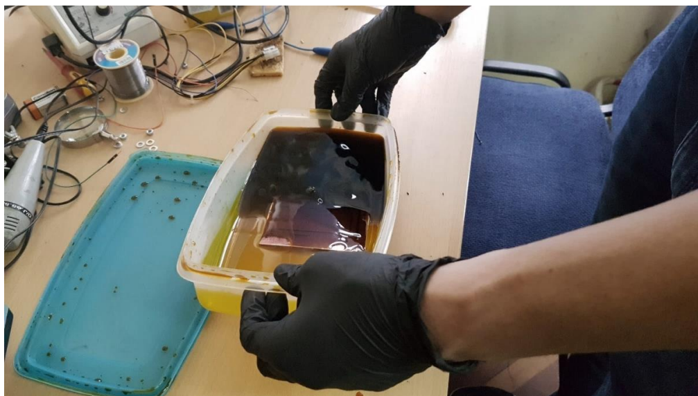
Slika 3.3. Nagrizanje (jetkanje) tiskane pločice u kiselini.
