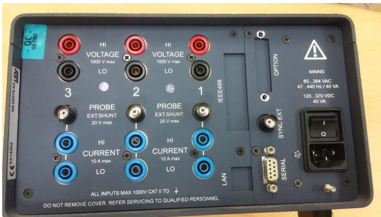
Slika 3.22. Izgled poledine analizatora snage NORMA 400.
