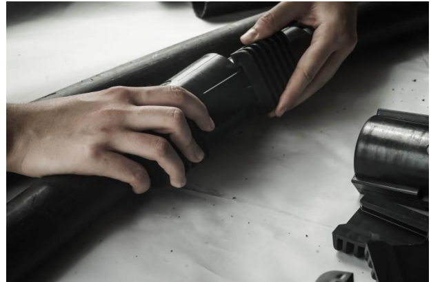
Slika 5.12: Postavljanje rebrastih brtvi na krajeve sklopivih spojnica
