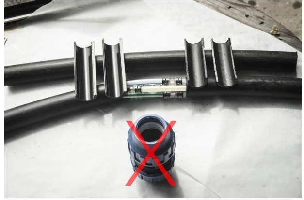
Slika 5.8: Reparacija cijevi isključivo reparaturnim kompletom
