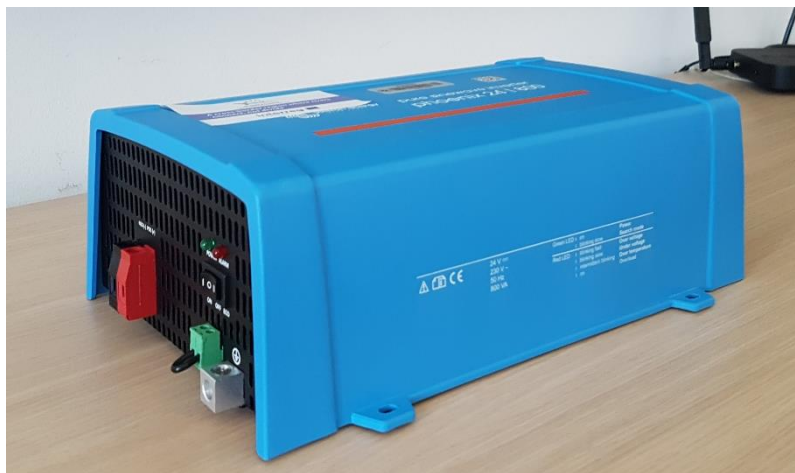
Slika 4.6. Otočni izmjenjivač Phoenix 24/800
