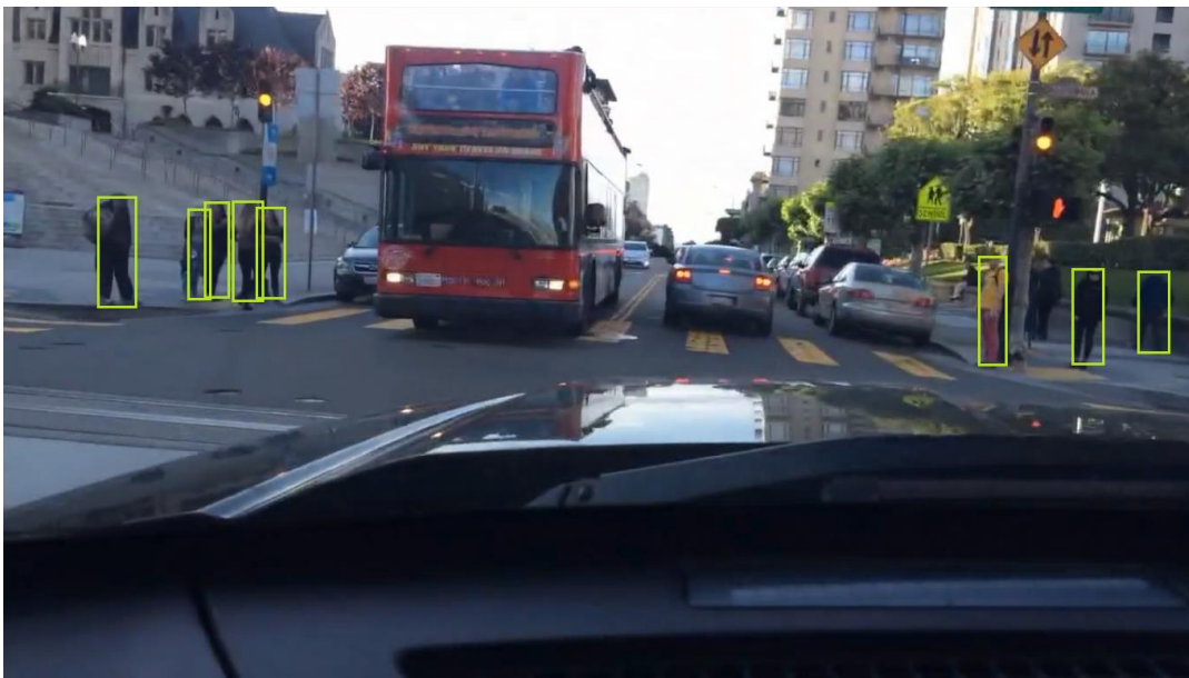
Sl. 4.1. Okvir videa na kojemu je odziv algoritma za detekciju pješaka zadovoljavajući
