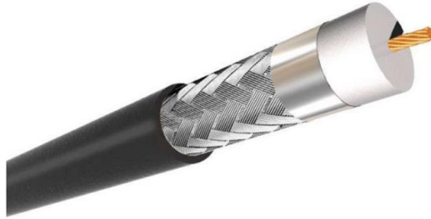
Slika 3.9 Koaksijalni kabel koji služi za povezivanje antene i kom. ormarića [12]
