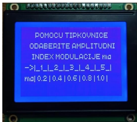
Slika 5.2. Odabir amplitudnog indeksa m_a
