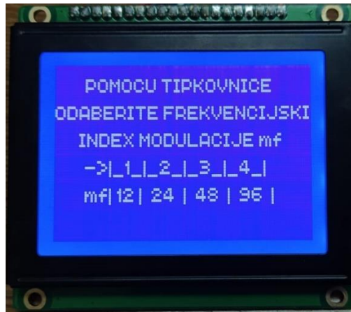
Slika 5.3. Odabir frekvencijskog indeksa m_f
