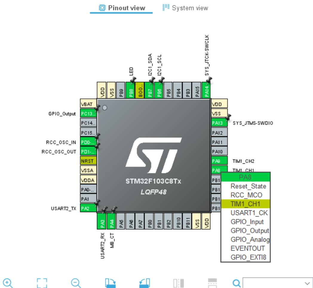
*Slika 3.5. Konfiguracijski prozor mikrokontrolera*
