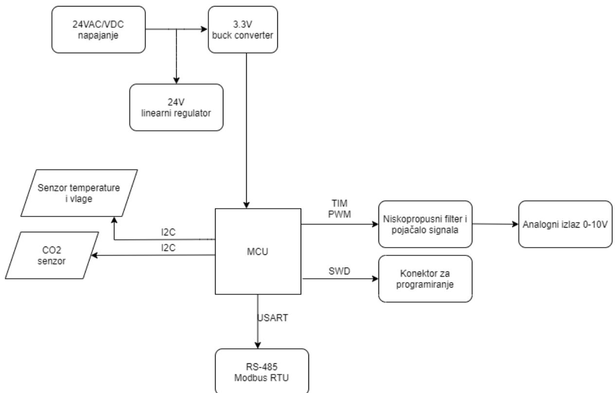
*Slika 3.1. Funkcionalni dijagram regulatora za upravljanje ventilacijom*
