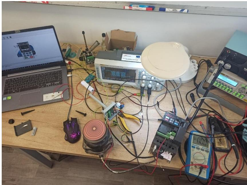
*Slika 4.4. Izgled testiranja regulatora u povratnoj vezi*
