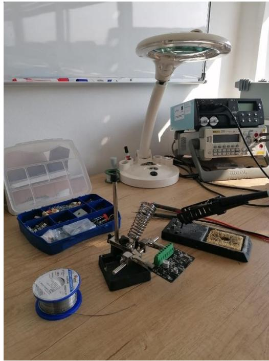
*Slika 3.12. Izrađena pločica spremna za lemljenje*
