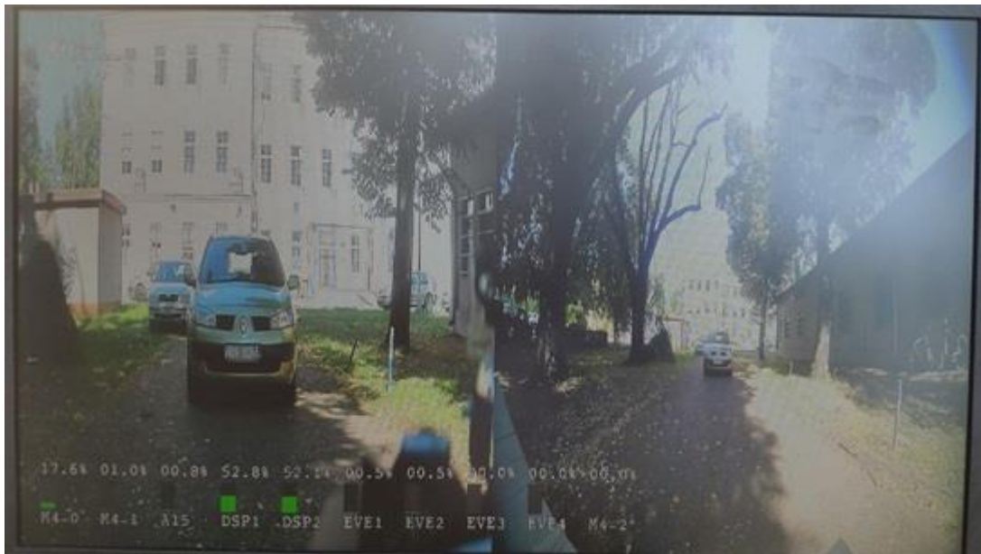
Sl. 4.1. Prikaz izlaznog signala na ekranu za korisnički slučaj s dvije kamere – zadnja i lijeva kamera
