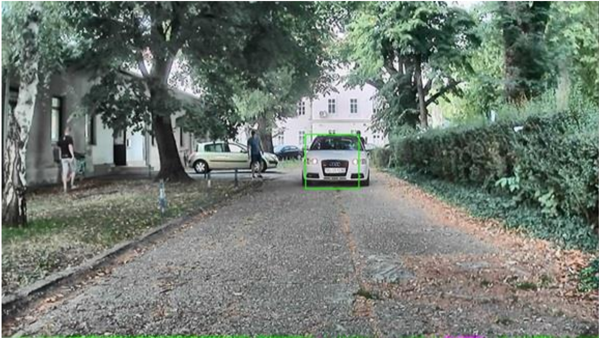
Sl. 4.9. Primjer ispravne detekcije automobila (V4 na udaljenosti 15 m).
