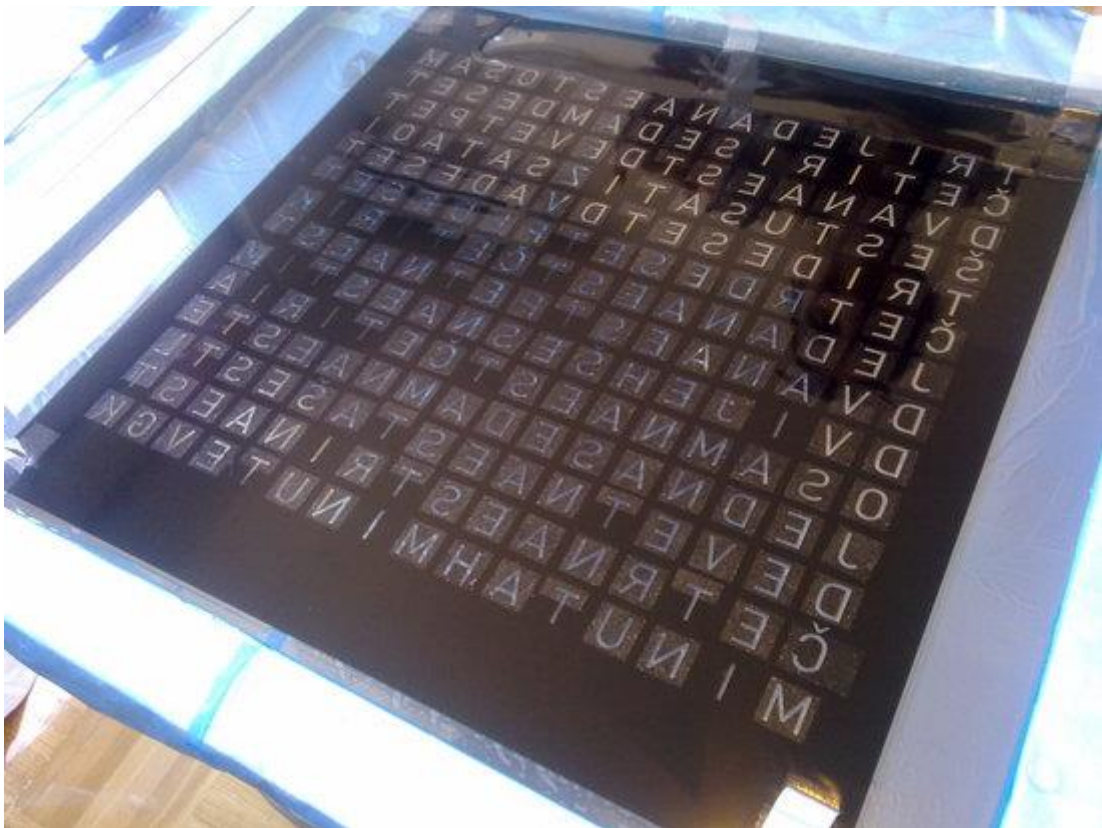
Slika 3.24: Lijepljenje folije na staklo [9]
