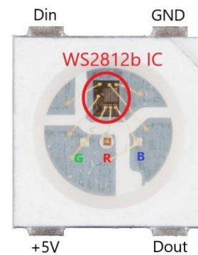
Slika 3.4: WS2812b LE dioda [4]
