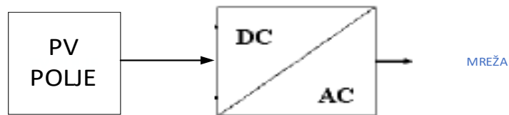
Slika 3.8. FN sustav s centralnim izmjenjivačem[13]
