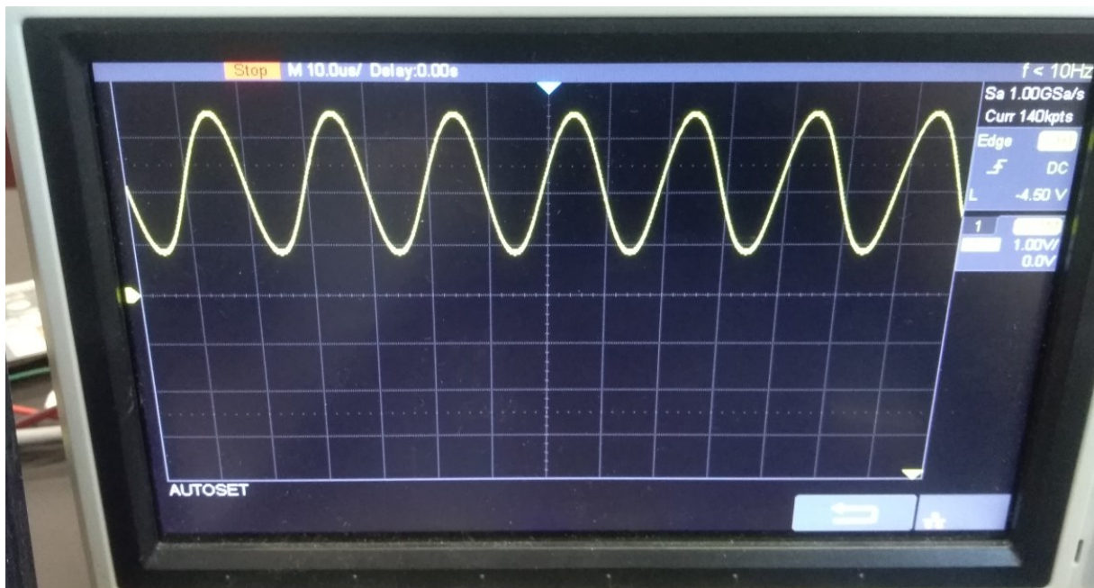
Slika 4.3.2 „Uspješno generirani sinusni signal 2V p-p 50 kHz“
