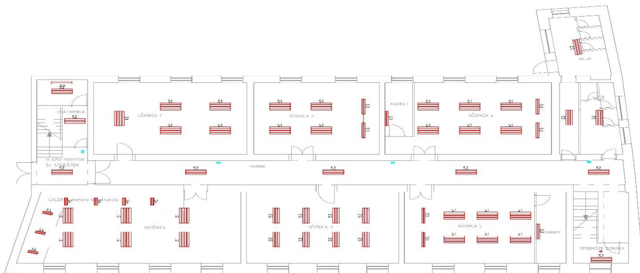
Slika 3.4. Tlocrt prizemlja – zatečeno stanje rasvjete
