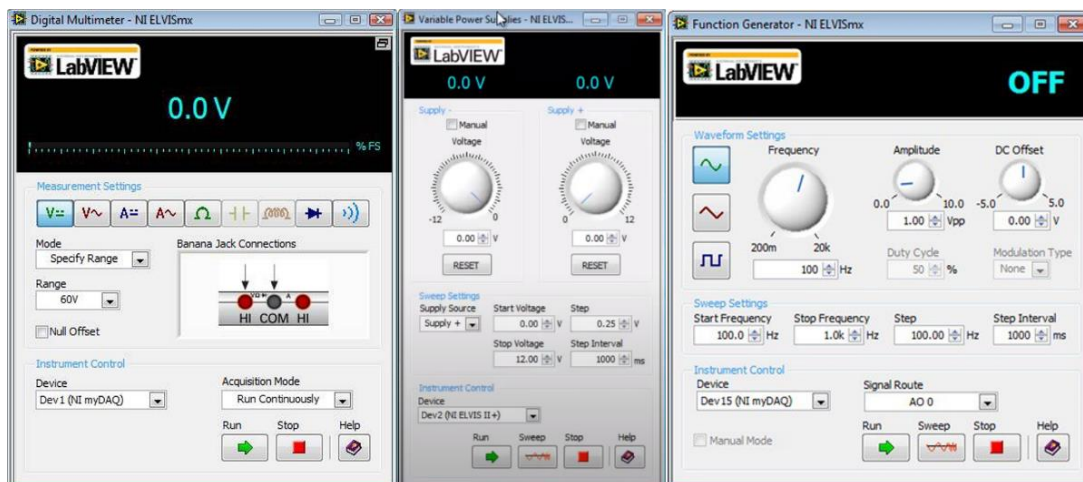
Slika 3.5. Primjeri NI ELVISmx virtualnih instrumenata [12]
