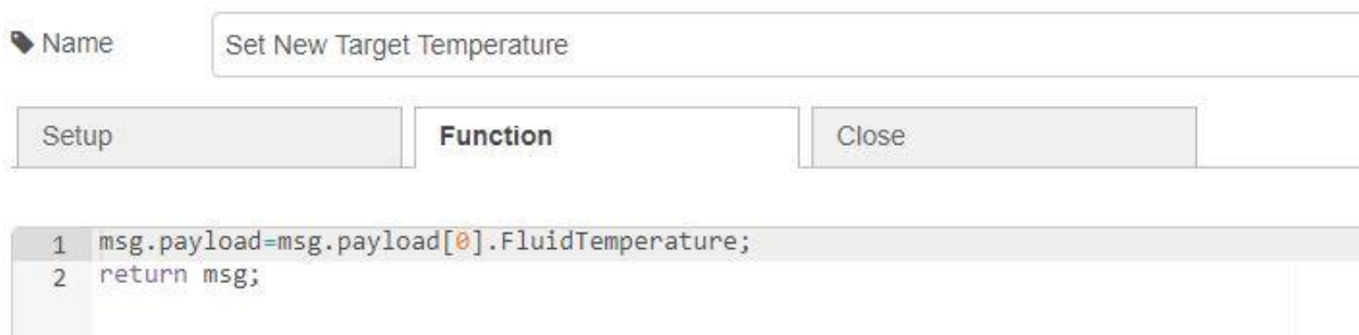
Slika 5.43 Kod funkcije „Set New Target Temperature“
