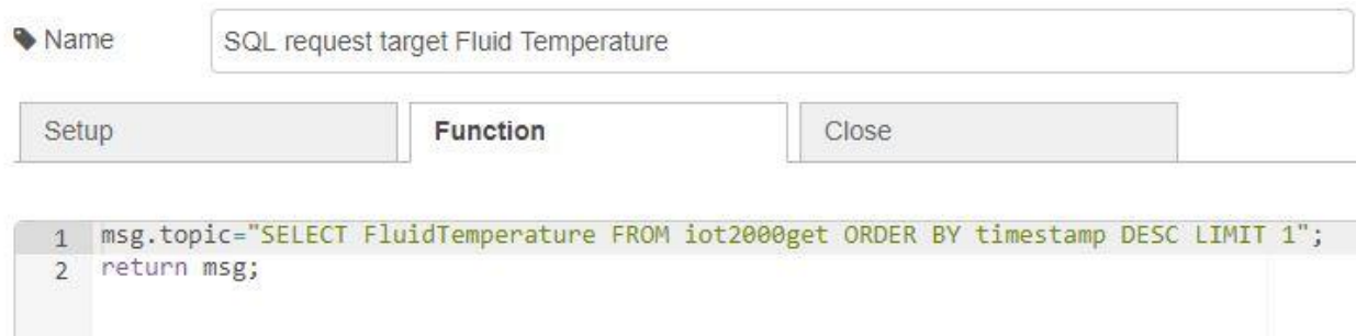
Slika 5.42 Kod funkcije „SQL request target Fluid Temperature“
