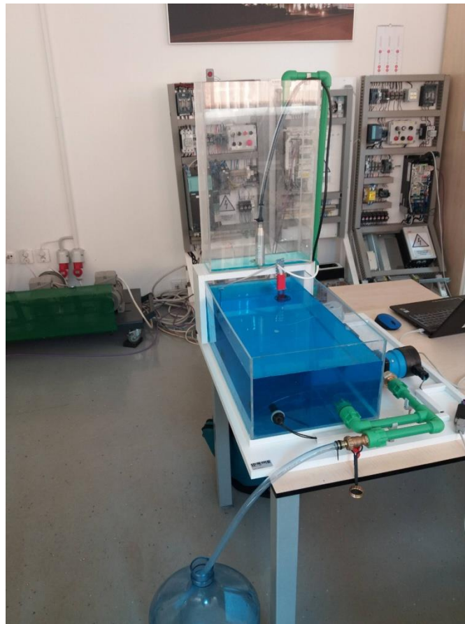
Slika 3.3 Maketa održavanja temperature i razine tekućine u spremniku
