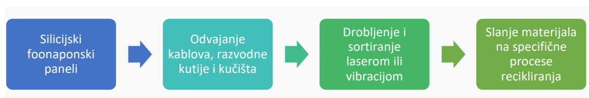
Slika 4.2. Tehnološki postupak recikliranja solarnih panela
