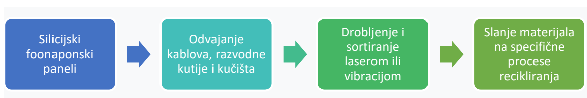
Slika 4.2. Tehnološki postupak recikliranja solarnih panela
