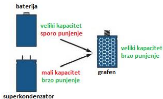
Slika 4.4. Prednosti grafenske baterije nad konvencionalnom baterijom i superkondenzatorom [16]
