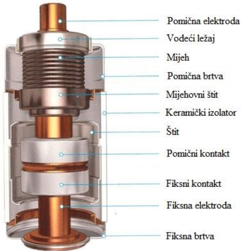
Sl.2.4. Presjek i komponente vakuumnog prekidača
