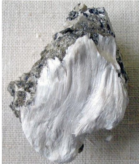
Slika 3.3. Vlknasti tremolitni azbest na muskovitu [23].
