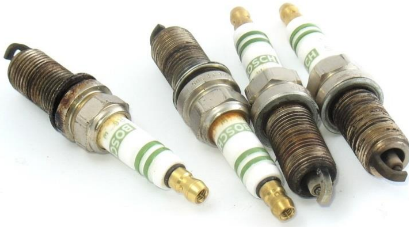
Slika 4.8. Središnja elektroda svjećice izolirana porculanom [8].
