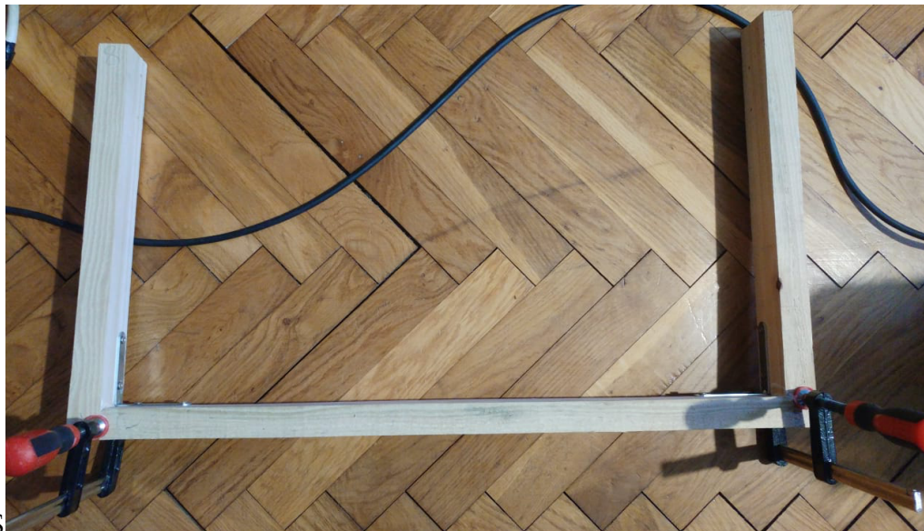
Slika 4.5. Učvršćivanje drvenog okvira
