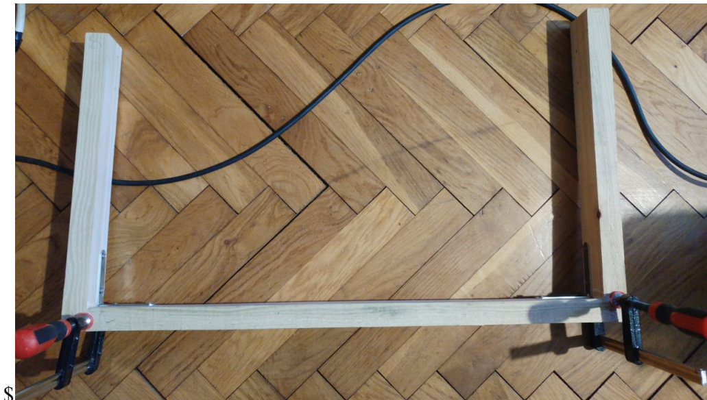
Slika 4.5. Učvršćivanje drvenog okvira
