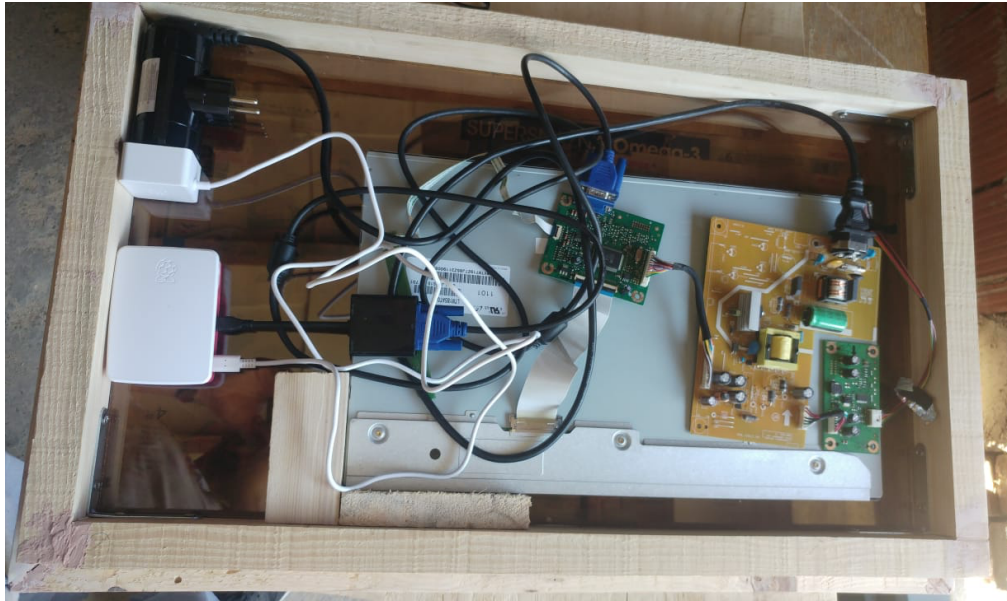
Slika 4.4. Prikaz zaslona i njegovih elektroničkih komponentata s Raspberryjem
