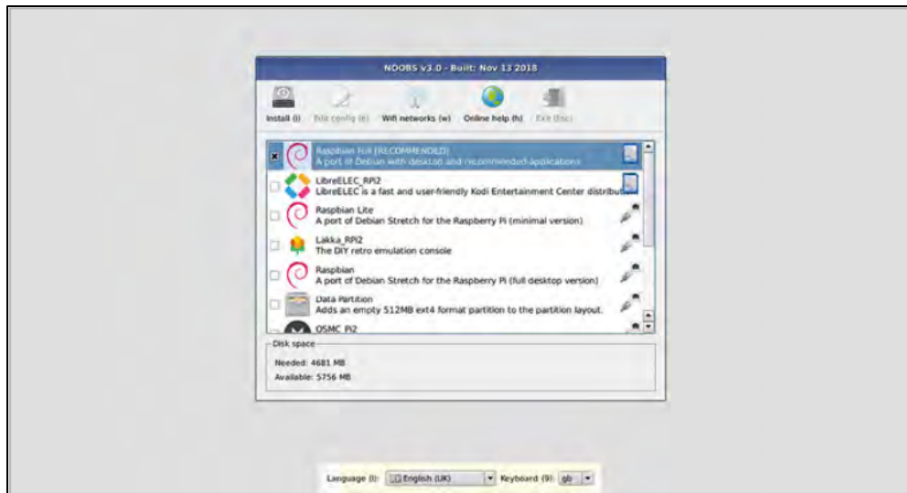
Slika 3.3. Odabir operativnog sustava za instaliranje putem NOOBS [11, str. 32]
